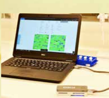
Mynd 6. MinION er ein nýggj sekvenseringsmaskina, sum er á stódd við eina farteleson og kann koplast til eina teldu við einum USB-stikki. Ætlanin var at nýta hana at avlesa silvurkyktaarvamassan, men tíverri gekk ikki sum ætlað. Myndir: Høvundar
