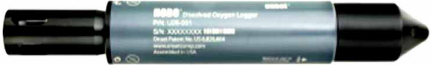
Mynd 3: Iltmátarar, sum máta støðugt – tískil ofta nevndir iltloggarar – eru settir út á nøkur av teimum støðum, har deyðir hummarar hava verið sæddir. Iltloggararnir eru inni í hummararúsunum, teir verða eftirkannaðir og mátingarnar verða fluttar yvir á teldu við jøvnum millumbilum.
